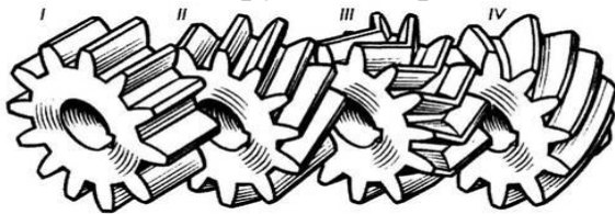
Рис.1 Зубчатые колеса: прямозубые, косозубые, шевронные, с круговыми зубьями
